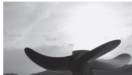
Figure 4. Backward tip rake propeller<sup>7)</sup>
