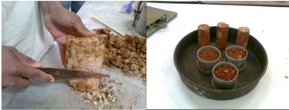
Figura 2. Labrado de especímenes para el ensayo triaxial
