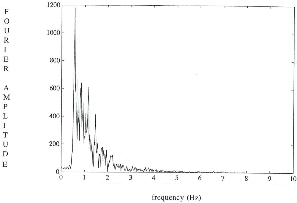
Fig. 13a. Fourier spectra. El Centro 1940, S00W component.
