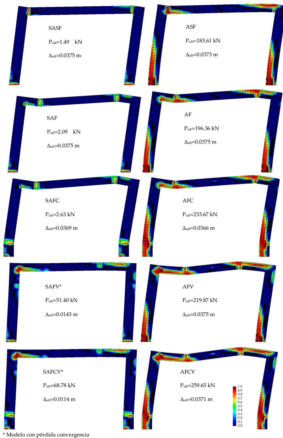
Figura 10. Daño en los modelos. Aplicación del desplazamiento en el extremo izquierdo
