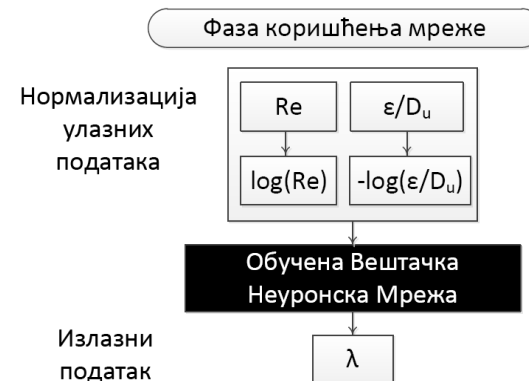
Slika 4 - Faza korišćenja neuronske mreže za simuliraciju Kolbrukove jednačine
